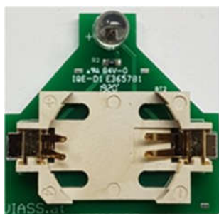
IR-LED para papel Con batería 3V CR2025
