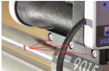
Paso 1: Apriete ligeramente los tornillos
